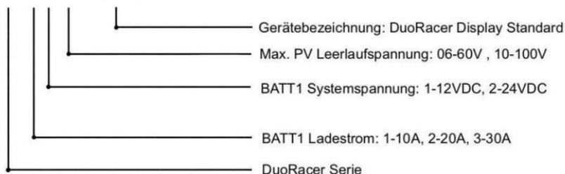
① Life Batterie (BATT1) ist die Energiespeicherbatterie für die Stromversorgung der Lasten in einem Inselfsystem. Unterstützte Batterietypen sind Sealed, Gel, Flooded, LiFePO4 und Li-NiCoMn-Batterien (der Laderegler kann die Systemspannung NICHT automatisch erkennen).
