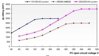
4. Die PV-Leerlaufspannung VS Max. PV-Eingangsleistung wie unten dargestellt:
