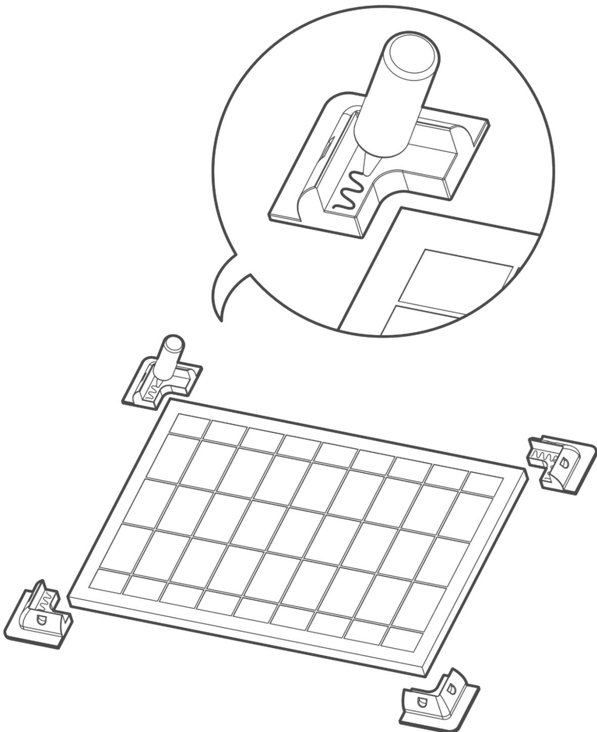
**Methode B:** mit Blechschrauben ST6.3 befestigen
