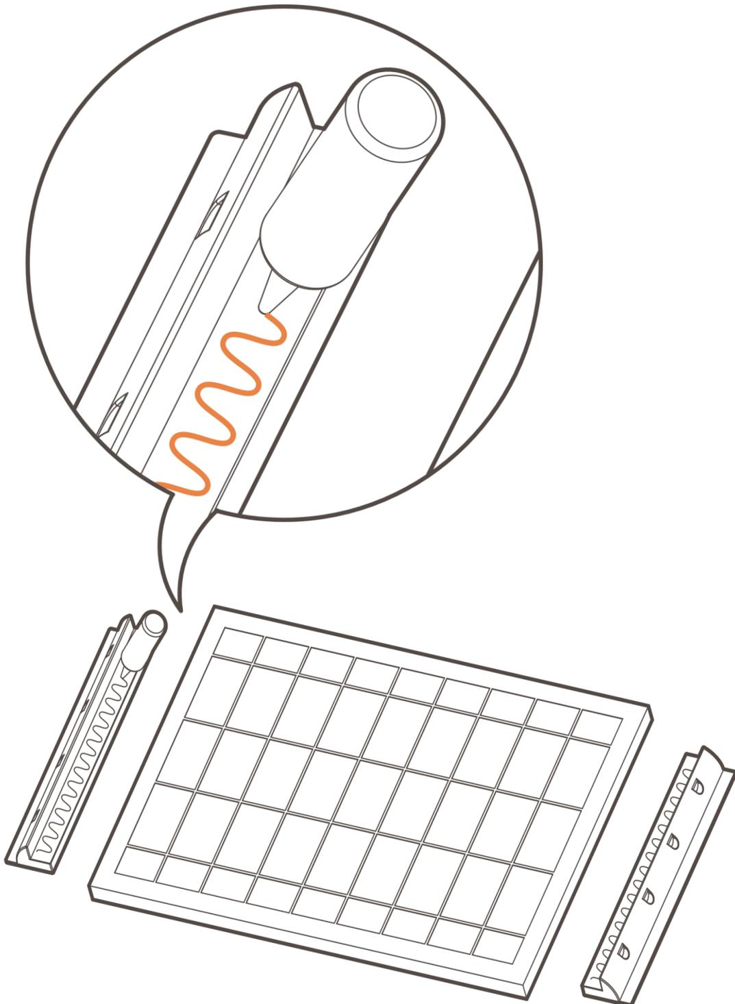
**Methode B:** mit Blechschrauben ST6.3 befestigen
