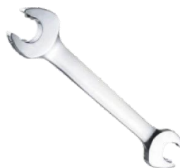
10er und 13er Gabelschlüssel für M6 und M8 Schrauben/
